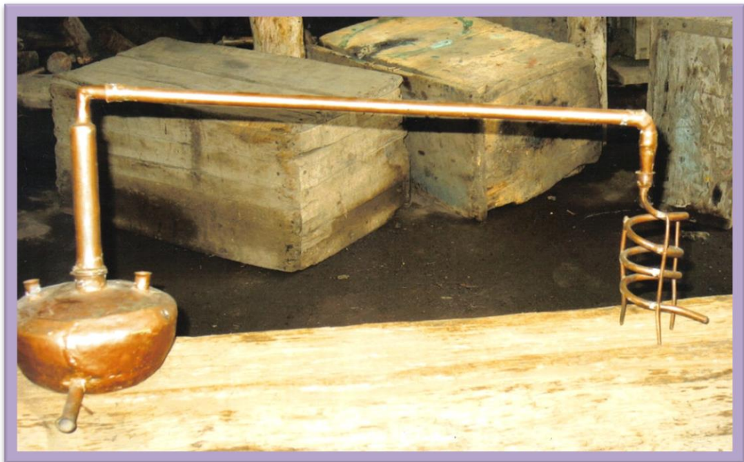
Alambique de cobre para la destilación del Trago
